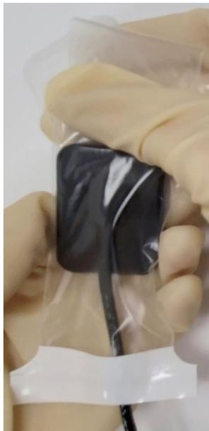
**Figures 7.** Retirer le capteur d'une gaine.
